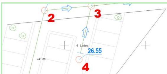
**Figura 129.** Colocación de cabezas de atarjea.
