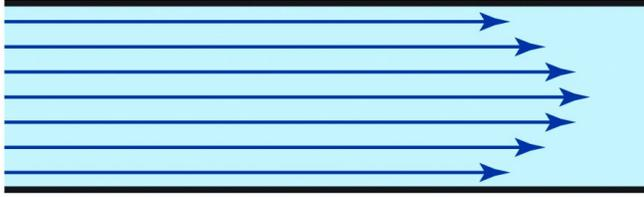
Ilustración 3 Esquema del flujo laminar.
