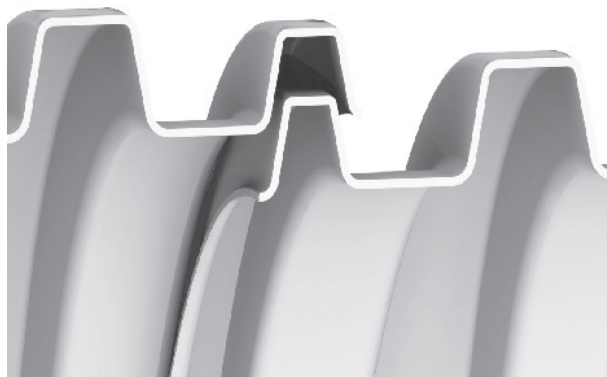
Figura 1. Empalme entre cámaras
