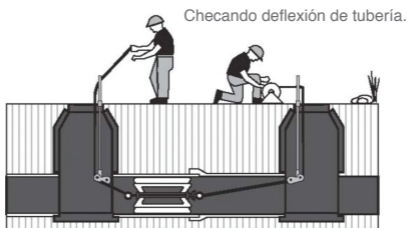
Figura 30. Prueba de paso de vía deslizando un mandril.
